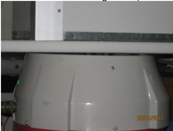
Foto 3. Modelo de prueba y adaptador sobre la mesa vibradora durante la prueba en el eje Z.
