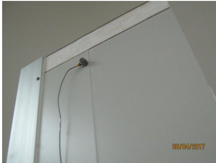
Foto. Localización del acelerómetro de respuesta en la estructura para la prueba en el eje X
