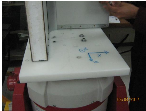
Foto Colocación del modelo de prueba Eje Z,
